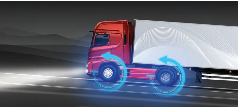
BERGANFAHRHILFE Verhindert das Zurückrollen beim Anfahren am Hang und unterstützt beim Halten des Fahrzeugs beim Bremsen oder auf rutschigen Straßen.
